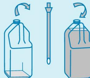
4. Retirer précautionneusement la canne d'aspiration. Dévisser le bouchon du nouveau bidon. Insérer la canne d'aspiration et placer le bidon dans son support.
